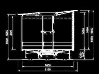
Schnell und einfach aufzubauendes Bühnendach-System. Gebaut und geprüft nach DIN EN 13814, EuroCode 3. Gültiges Baubuch vorhanden.
